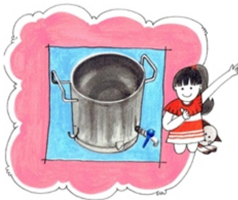
รูปที่ 6 แสดงหม้อควบนุ่นของเครื่องกลั่นน้ำส้มควันไม้
