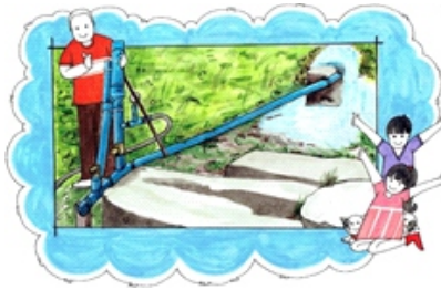
รูปที่ 9 แสดงการติดตั้งการใช้งานเครื่องตะบันน้ำ
